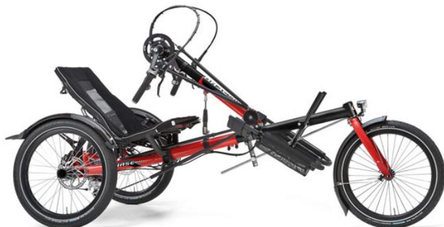
Hand bike high tech : la propulsion aux roues arrière assure une bonne motricité en montée.
