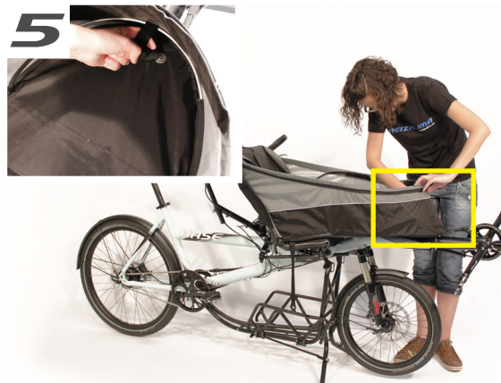
Schritt 5: Ziehen Sie den Bügel hoch. Step 5: Pull the inside bow upright.
